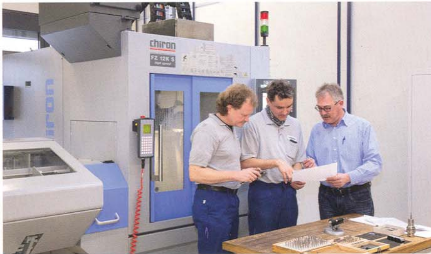
2 Zeitsparende Komplettbearbeitung inklusive QS: Einschließlich Entgraten, Messen sowie Protokollieren erzielt Synthes mit der FZ 12 rekordverdächtige Stückzeiten von durchschnittlich 28 Minuten; (von links: Wolfgang Ley, Rainer Link, Ulrich Jäggle)
