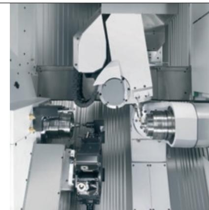
3 Blick in den Arbeitsraum der FZ12 MT mit Schwenkopf, Drehspindel, Werkzeugrevolver und optionaler Gegenspindel
