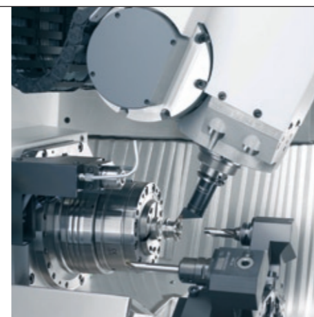
2 Im Bild unten der Werkzeugrevolver mit zwölf Werkzeugen und vollwertiger Drehfunktion
