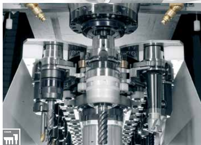
Cambio utensile automatico con sistema pick-up a partire da 1,5 s (40 posti utensile)
